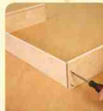
11. Соедините заднюю и боковые стенки ящика саморезом 4x40
