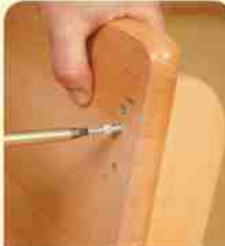
5. Выкрутите шпигт эксцентрика в столешницу
