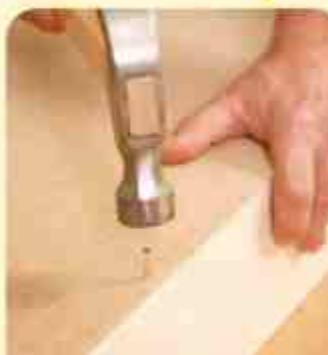
16. Зафиксируйте ДВП на задней стенке ящика
